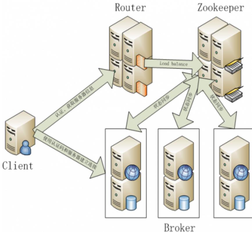
TimeTunnel是一个实时数据传输平台，TimeTunnel的主要功能就是实时完成海量数据的交换，因此TimeTunnel的业务逻辑主要也就有两个：一个是发布数据，将数据发送到TimeTunnel；一个是订阅数据，从TimeTunnel读取自己关心的数据。TimeTunnel作为一个实时数据传输平台具有以下特点：
