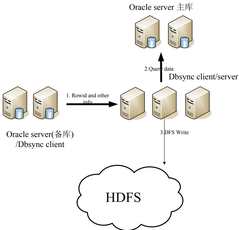
dbsync是一个用于同步服务库数据到HDFS的产品，通过分析数据库服务器的log文件来提取相应的数据库动作，进而达到数据库到HADOOP的数据同步，供相关部门提取增量数据。
